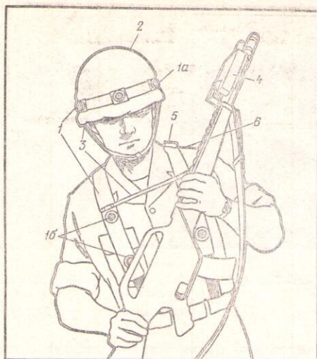
Рис. 4. Американская система имитации прямого огня IDFSS: 1 — комплект приемников лазерного излучения (1а — на каске, четыре штуки; 1б — на снаряжении, четыре штуки); 2 — звуковой сигнализатор (с внутренней стороны каски); 3 — антенна контурного типа; 4 — лазерный передатчик; 5 — устройство индикации попадания; 6 — электронный блок управления и передачи данных (крепится на спине)
